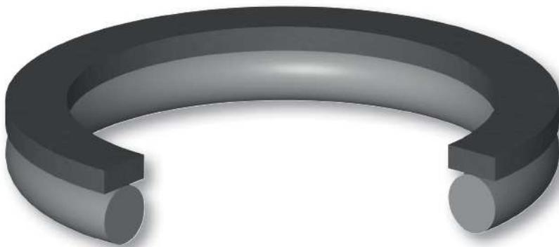
La funzione dell'anello antiestrusione tipo BRC di Aston Seals è quella di evitare il danneggiamento dell'O-Ring che avviene normalmente in presenza di elevati giochi d'accoppiamento o pressioni elevate.
