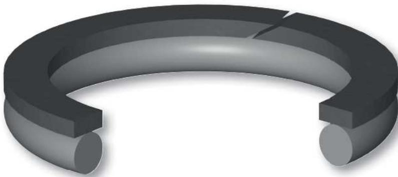
La funzione dell'anello antiestrusione tipo BRT di Aston Seals è quella di evitare il danneggiamento dell'O-Ring che avviene normalmente in presenza di elevati giochi d'accoppiamento o pressioni elevate.
