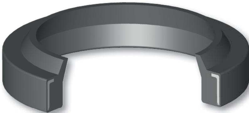
La funzione del raschiatore stelo tipo SMI di Aston Seals è quella di prevenire l'introduzione di polvere, sporcizia e materiale estraneo all'interno del sistema di tenuta. Questo è ottenuto grazie ad uno speciale labbro raschiante che produce un'effettiva azione pulente, previene lo sviluppo di scorie, protegge gli elementi di guida e allunga la vita in esercizio delle guarnizioni di tenuta.
