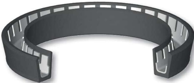
La KV di Aston Seals è una tenuta pistone a semplice effetto a labbro, energizzata da una molla metallica a V resistente alla corrosione.
