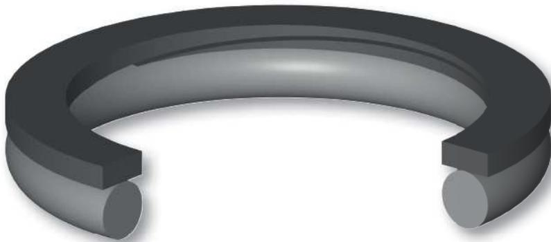
La funzione dell'anello antiestrusione tipo BRA di Aston Seals è quella di evitare il danneggiamento dell'O-Ring che avviene normalmente in presenza di elevati giochi d'accoppiamento o pressioni elevate.
