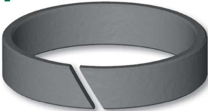
L'anello di guida tipo FI di Aston Seals è stato sviluppato per sostituire le tradizionali guide in bronzo nei cilindri idraulici. Guida lo stelo ed evita contatti metallici con la testata del cilindro in presenza di forze radiali che agiscono in direzione perpendicolare al movimento.
