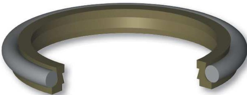
La funzione del raschiatore stelo tipo S2A di Aston Seals è quella di prevenire l'introduzione di polvere, sporcizia e materiale estraneo all'interno del sistema di tenuta. Questo raschiatore può esercitare una efficace azione di tenuta supplementare se utilizzato con una tenuta stelo con buone caratteristiche di ritorno idrodinamico. È composta da:
