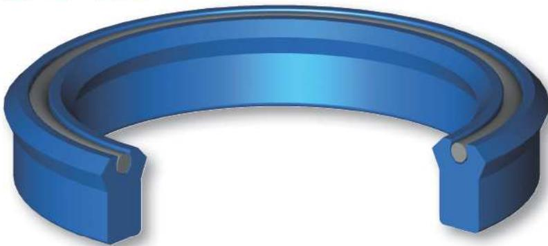
La guarnizione tipo UPN di Aston Seals, naturale evoluzione della UP, è adatta sia per lo stelo che per il pistone e combina i vantaggi dell'elasticità della gomma nitrilica con la resistenza all'abrasione del poliuretano.
