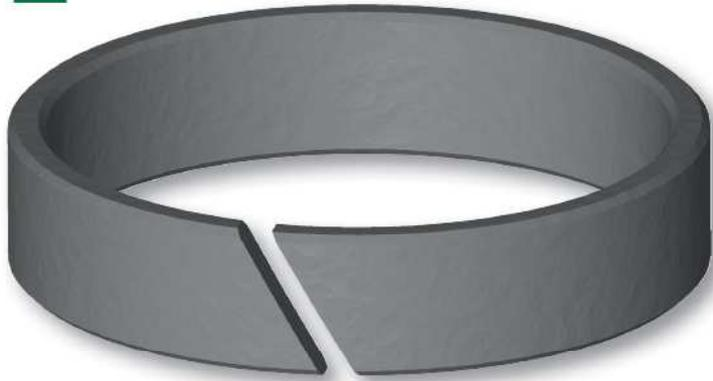
L'anello di guida tipo FE di Aston Seals è stato sviluppato per sostituire le tradizionali guide in bronzo nei cilindri idraulici. Guida il pistone ed evita contatti metallici col cilindro in presenza di forze radiali che agiscono in direzione perpendicolare al movimento.
