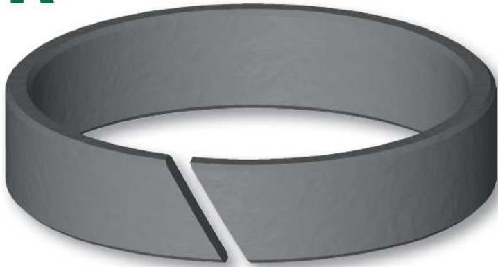
L'anello di guida tipo FR di Aston Seals è stato sviluppato per sostituire le tradizionali guide in bronzo nei cilindri idraulici. Guida lo stelo o il pistone ed evita contatti metallici col cilindro in presenza di forze radiali che agiscono in direzione perpendicolare al movimento.
