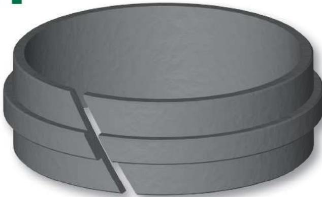
L'anello di guida tipo FIT di Aston Seals è stato sviluppato per sostituire le tradizionali guide in bronzo nei cilindri idraulici. Guida lo stelo ed evita contatti metallici con la testata del cilindro in presenza di forze radiali che agiscono in direzione perpendicolare al movimento.
